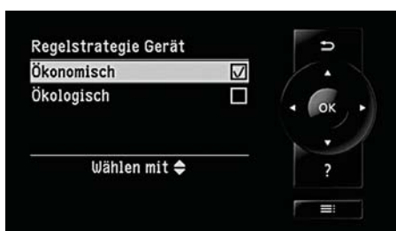
Regelung Vitotronic 200 mit Hybrid Pro Control – Auswahl der Betriebsart „Ökonomie“ oder „Ökologie“
